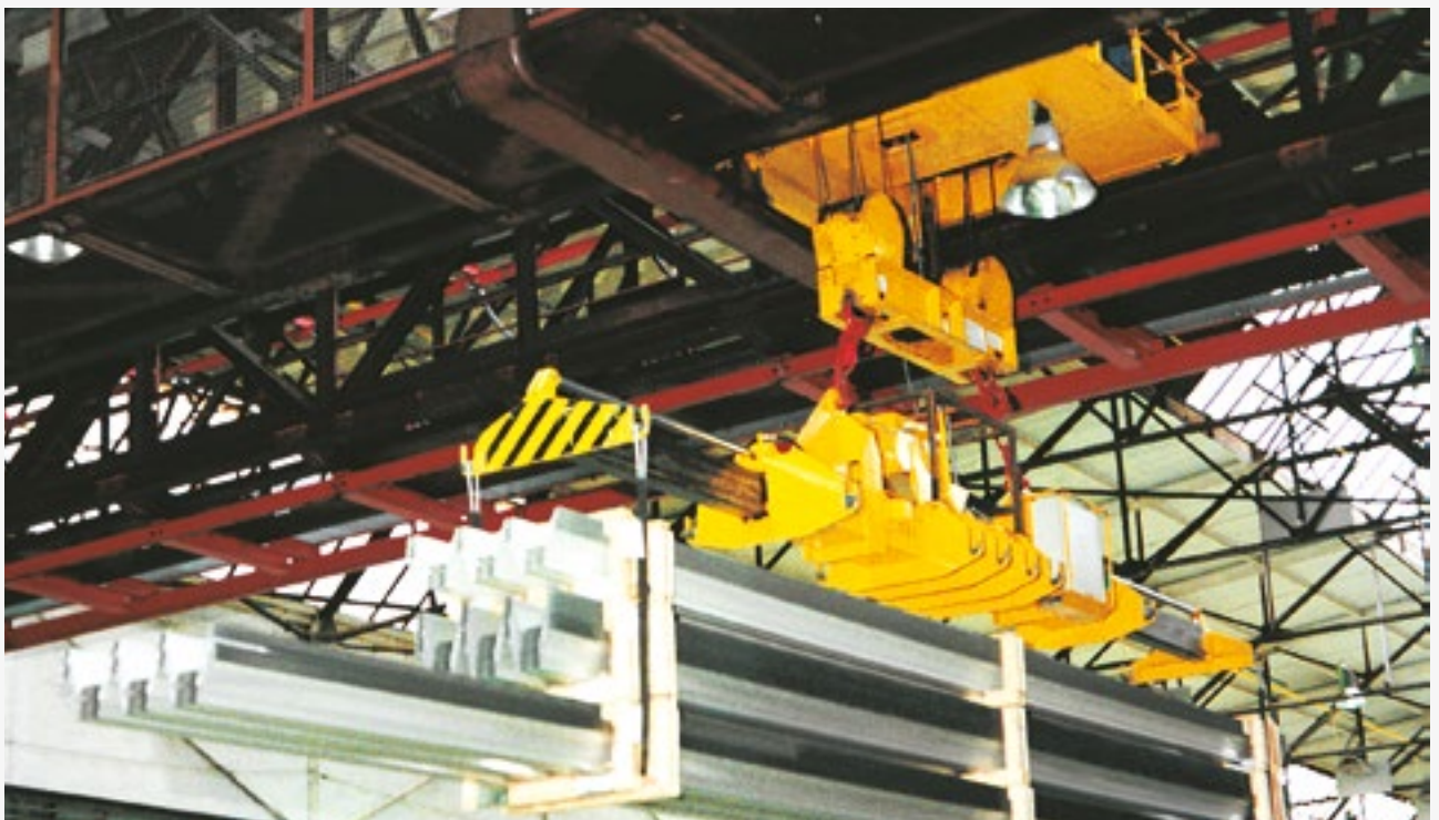
Teleskoptraverse, hydraulisch angetrieben Hydraulically driven telescopic spreader
