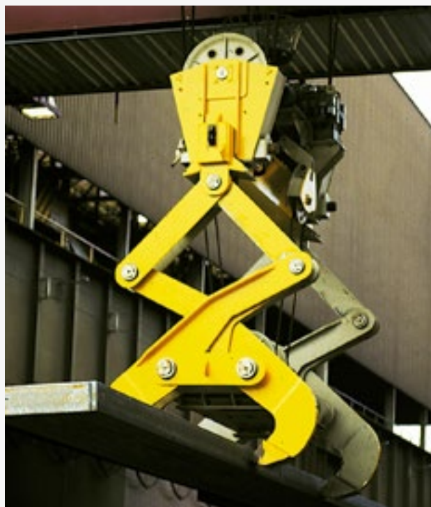
Doppelbrammenzange in mechanischer Scherenbauweise mit motorischer Greifweitereinstellung
