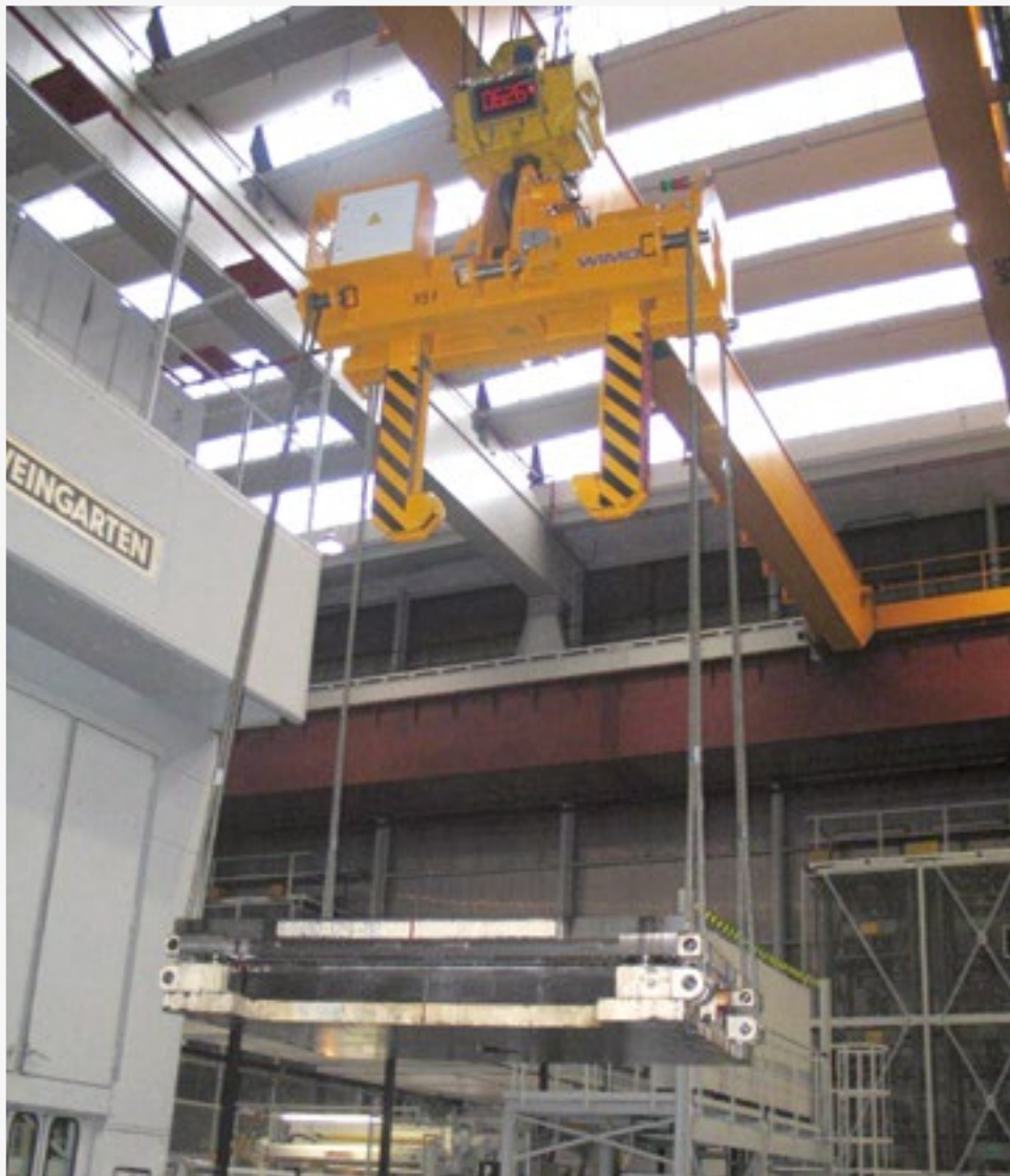
Teleskop-Coilzange mit Spindeltrieb für den Transport von Coils und Presswerkzeugen Telescopic coil gripper with spindle drive for transporting coils and press tools
