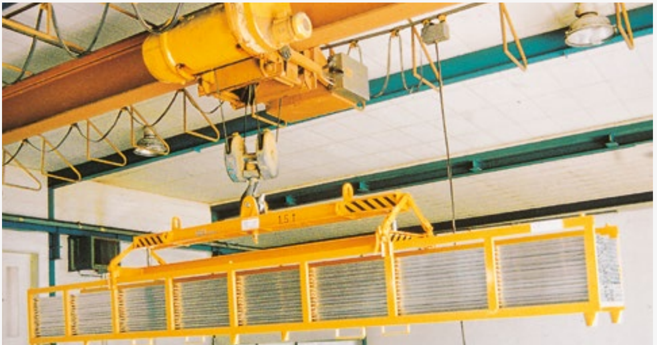
Langgutzange in mechanischer Ausführung mit automatischer Offenhalteeinrichtung
