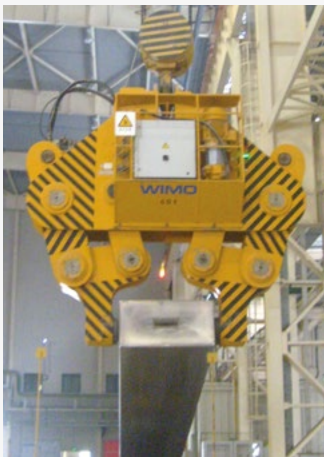
Brammenzange mit hydraulischem Zangenarmtrieb für das Aufrichten, Ablegen und den vertikalen Transport
