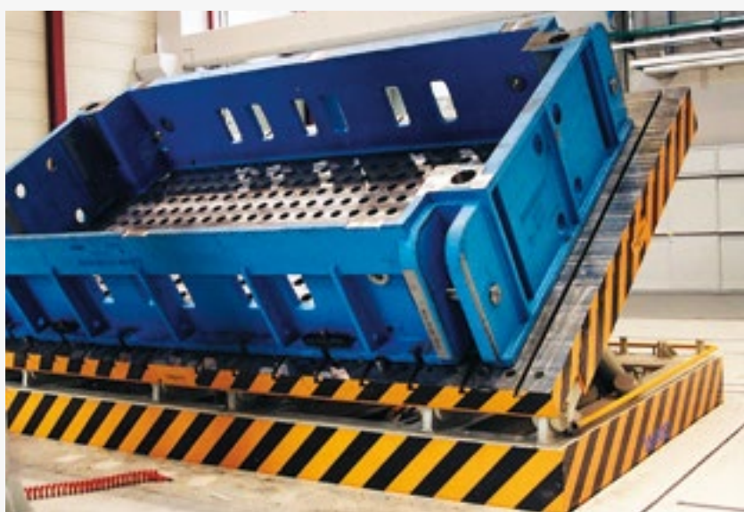
Scherenhubtisch mit Schwenkplatte, hydraulisch angetrieben, für gute Zugänglichkeit bei Arbeiten an Presswerkzeugen. Die Einrichtung ist bis auf Hallenbodenhöhe versenkbar
