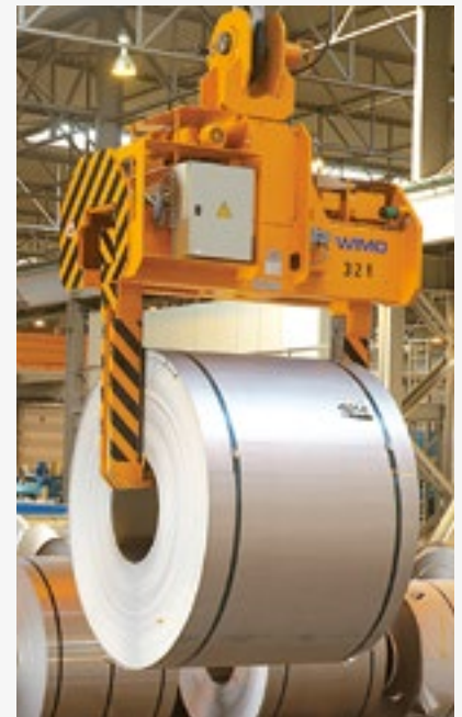
Teleskop-Coilzange mit Kettenantrieb und motorischer Horizontal-Dreheinrichtung
