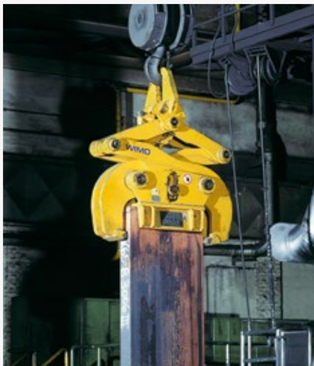
Blockzange in mechanischer Scherenbauweise mit automatischer Offenhalteeinrichtung für vertikalen Transport
