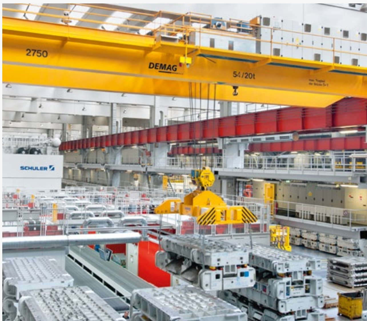
Teleskoptraverse in hydraulischer Ausführung für den Transport von Presswerkzeugen Hydraulical telescopic spreader for transporting press tools
