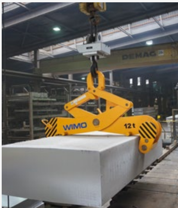
Brammenzange in mechanischer Scherenbauweise mit automatischer Offenhalteeinrichtung für horizontalen Transport
