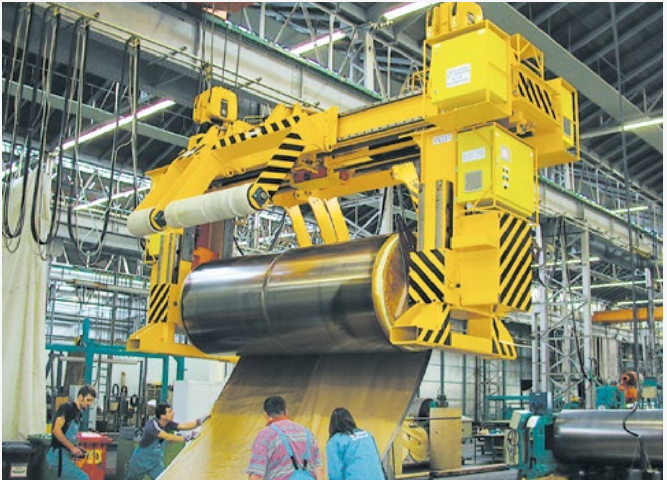
Coil Hängehaspel zum Auf- und Abwickeln von Dünblechen bei der Oberflächenbearbeitung. Ausführung mit Spreizbacken zur Coilaufnahme, verstellbaren Schlitten zur Anpassung an die Coillbreiten, Andrückrollen und höhenverstellbaren Absetzfüßen. Die Steuerung ist mit einer sensiblen Regelung für die Bandgeschwindigkeit ausgestattet
