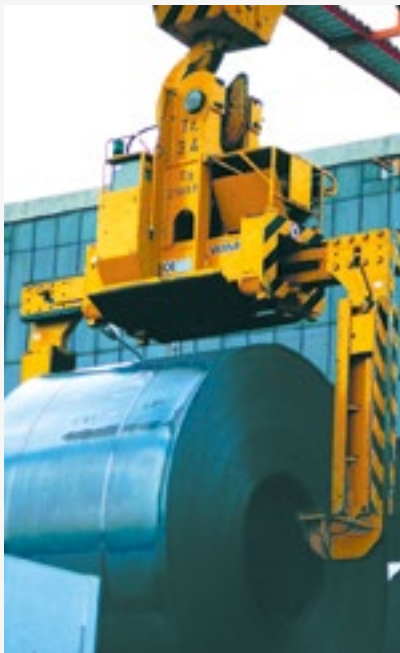
Teleskop-Coilzange mit Zahnstangeantrieb
