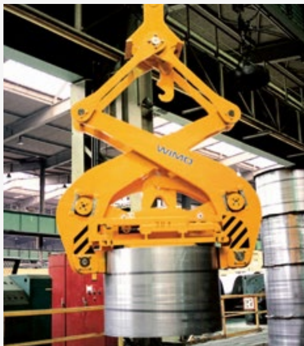
Vertikal-Coilzange in mechanischer Ausführung mit doppelseitiger Lastaufnahme
