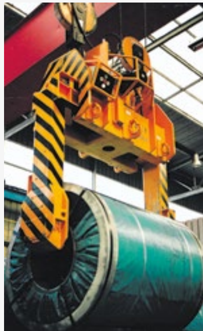
Teleskop-Coilzange mit Hydraulikantrieb und klappbaren Aufnahmepratzen
