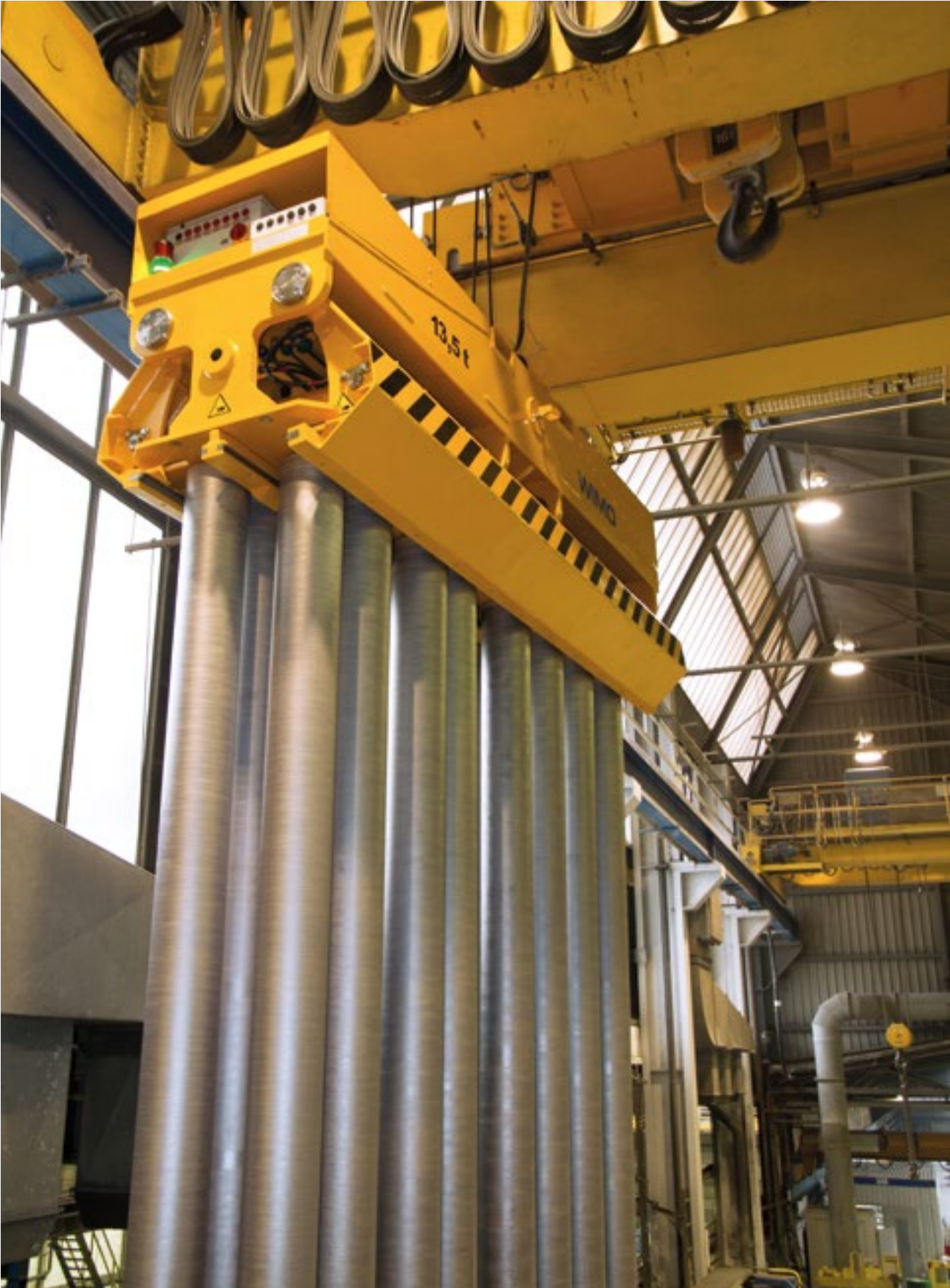
Brammenzange hydraulisch angetrieben für vertikalen ein- oder zweireihigen Transport
