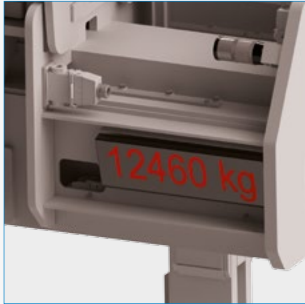
Wägeeinrichtung In die Coilzange integriert
